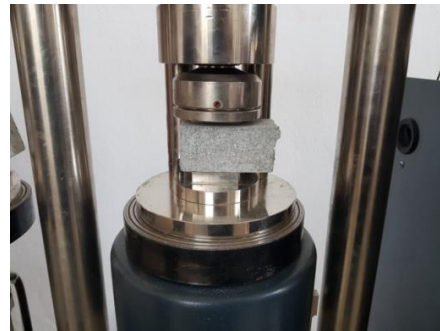
Figura 2: Testet e tullës dhe llacit në shtypje
