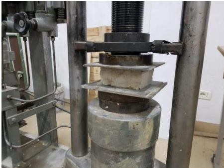
Figura 2: Testet e tullës dhe llacit në shtypje
