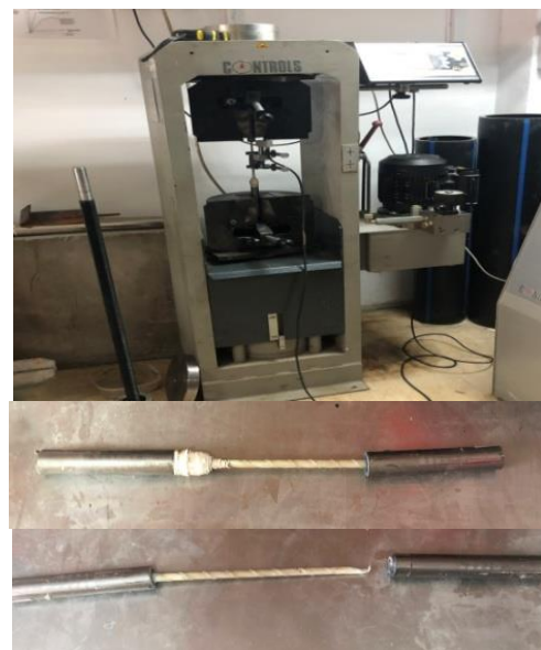
Fig.2 Testimi në laborator i shufrave GFRP
